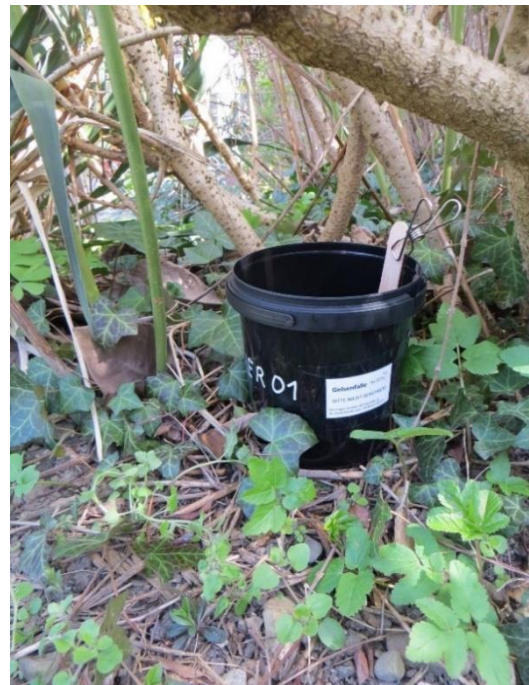
Abb. 2: Ovitrap (Eigelegefalle), bestehend aus einem schwarzen, wassergefüllten Becher und einem Holzstäbchen, auf dem die Eier abgelegt werden können.
