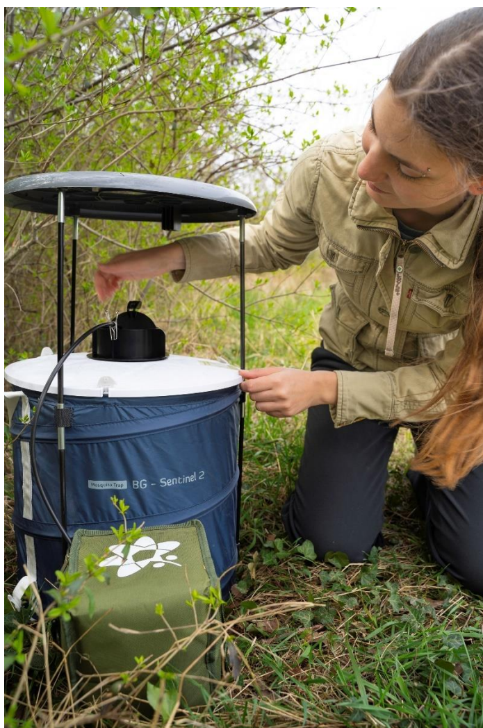
Abbildung 3: Für das Monitoring eingesetzte Stechmückenfalle (BG-Sentinel 2) mit der angeschlossenen CO 2 -Quelle (BG-Generator, in der grünen Isoliertasche).
